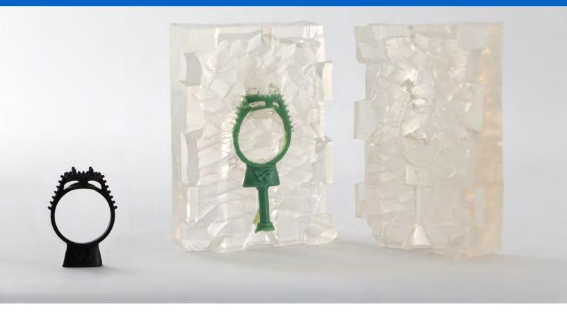
Le silicone RTV peut être transparent, ce qui aide à découper des moules avec des géométries complexes.
