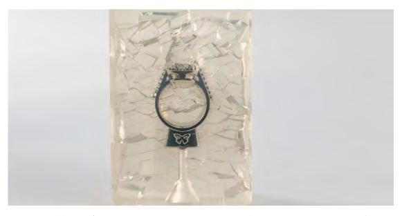
Le moulage RTV ne nécessite pas de cuve de vulcanisation et l'investissement initial est plus faible, mais les coûts de fonctionnement pour les matériaux sont plus élevés.
